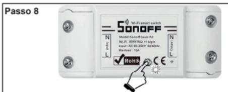
Ora il relè è pronto per essere abbinato al Gateway, fare un click veloce sul pulsante del relè in modo da abbinare il relè al proprio Spot termostato.
