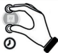
Premere a lungo sul termostato Spot fino a tornare al menù principale.
